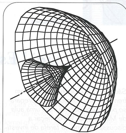
figura 9 - O parabolóide de revolução e a superfície gerada pela evoluta da parábola.
