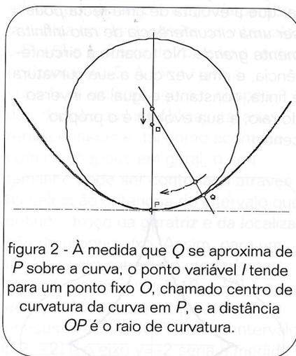
figura 2 - À medida que  $Q$  se aproxima de  $P$  sobre a curva, o ponto variável  $I$  tende para um ponto fixo  $O$ , chamado centro de curvatura da curva em  $P$ , e a distância  $OP$  é o raio de curvatura.
