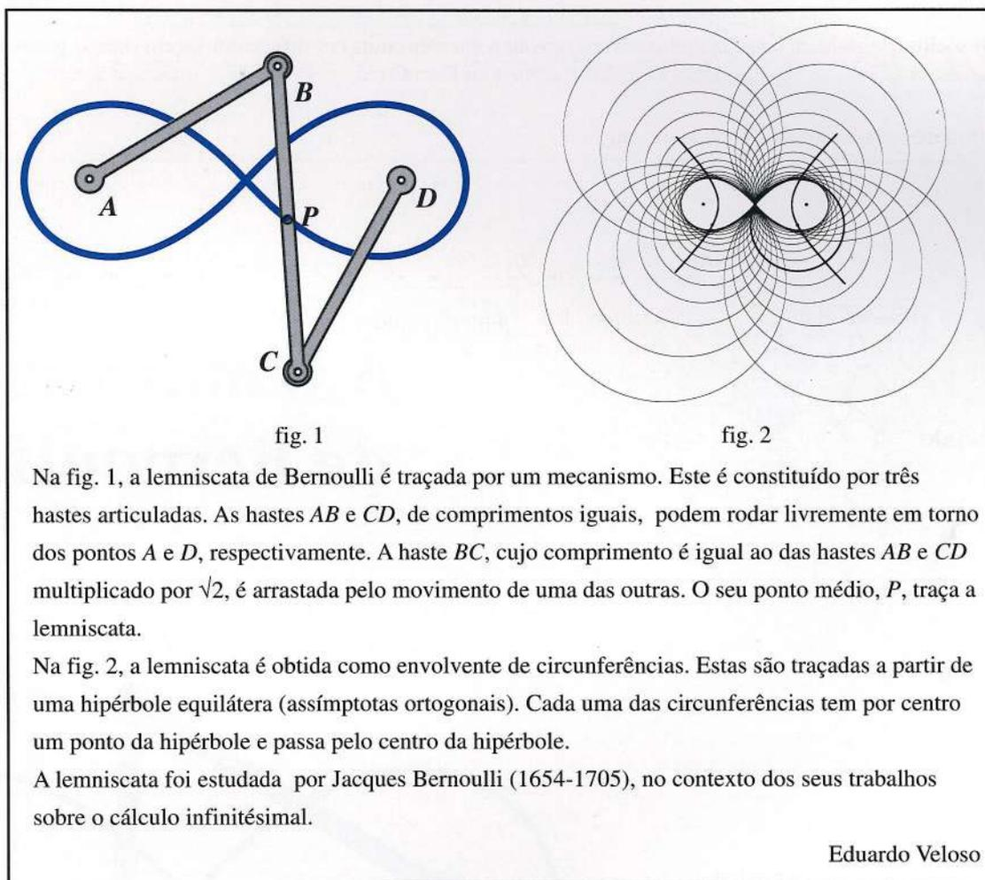
Na fig. 1, a lemniscata de Bernoulli é traçada por um mecanismo. Este é constituído por três hastes articuladas. As hastes  $AB$  e  $CD$ , de comprimentos iguais, podem rodar livremente em torno dos pontos  $A$  e  $D$ , respectivamente. A haste  $BC$ , cujo comprimento é igual ao das hastes  $AB$  e  $CD$  multiplicado por  $\sqrt{2}$ , é arrastada pelo movimento de uma das outras. O seu ponto médio,  $P$ , traça a lemniscata.
