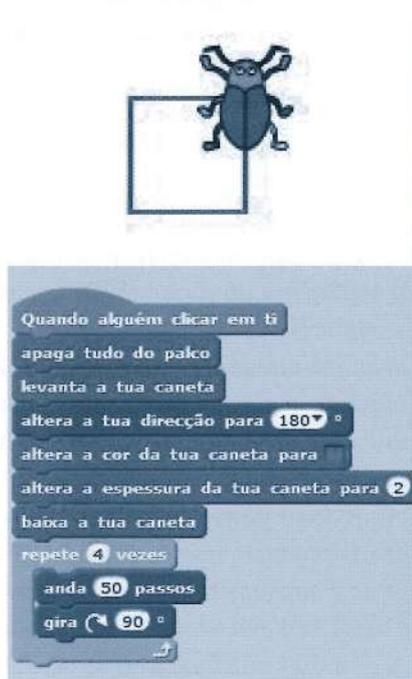
Figura 4. Construção de um quadrado.
