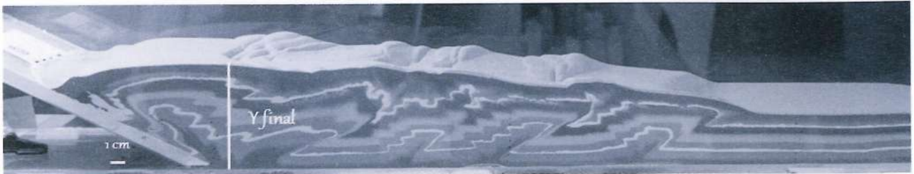
Figura 4. Aspecto final da simulação da zona externa da cadeia de montanhas. À medida que se puxa o acetato, a pilha de areias encurta (x) e aumenta a espessura (y).
