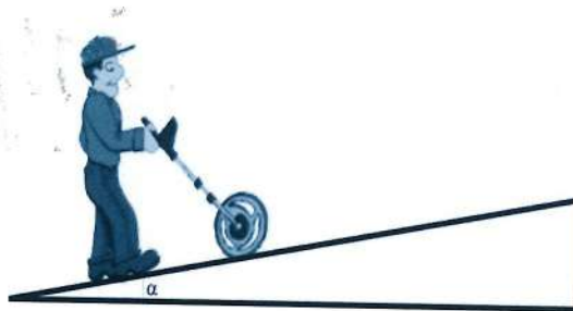
Figura 2. Medição da distância para determinação do desnível de uma estrada pelo método tradicional. O ângulo \alpha é determinado usando um teodolito.
