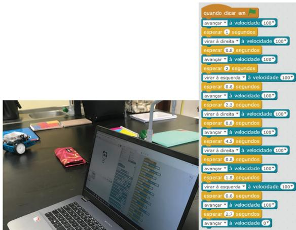
Figura 10. Exemplo de programação do labirinto com o robô mBot realizado por um grupo
