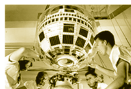
Satélite Telstar, lançado em 1962 Forma «esférica» com placas retangulares
