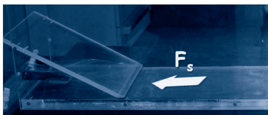
Figura 3a. As areias são despejadas em cima de um acetato. Este passa por baixo da rampa, e é puxado lentamente à mão. O acetato simula a placa de subducção. F_s = Força exercida sobre o acetato.
