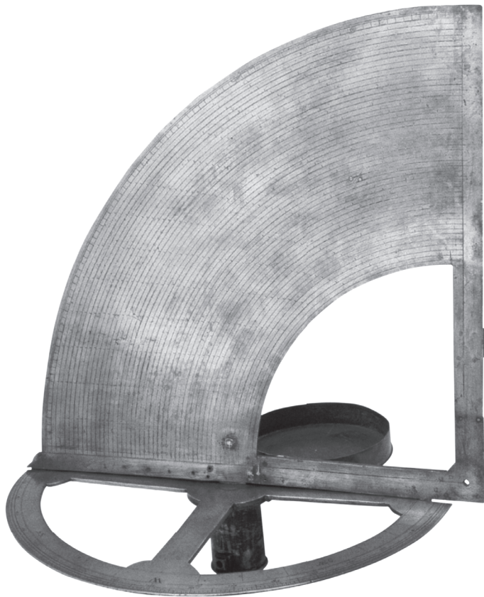
Figura 1. Quadrante fabricado por James Kynnuyn, em 1595. É possivelmente o único instrumento que existe dispondo do Nónio de Pedro Nunes [Reis, 1999]. [3]
