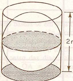
Ao colocarem a esfera dentro do cilindro cheio de água, cujo volume foi previamente medido, irão concluir que o volume de água deslocado é 2/3 do volume total inicial e portanto
